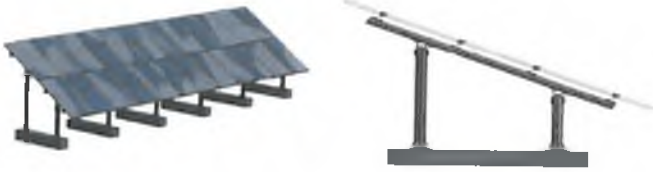
Şekil 1:Sahaya Montaj Uygulama detayları
