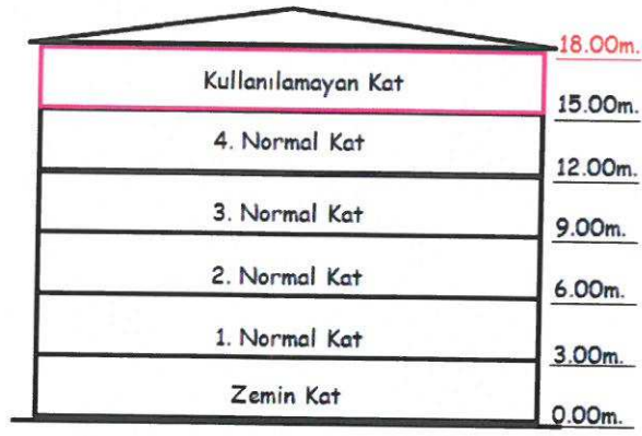
Şekil 2. Zemin kat 3m. olarak kullanıldığında
